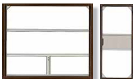
Cadre pour porte basculante et porte de service séparée (Bocholt) pour remplissage de max. 7 kg/m²
